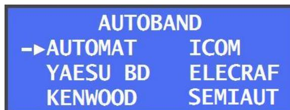
Auswahl: **AUTOMAT**: Automatische Bandauswahl über den internen Decoder. Nur die Leitung für **TX GND/PTT** wird benötigt.
